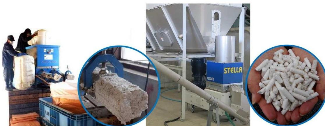
図 17 使用済み発泡スチロール製フロートの減容リサイクル技術と減容ペレット化のイメージ
