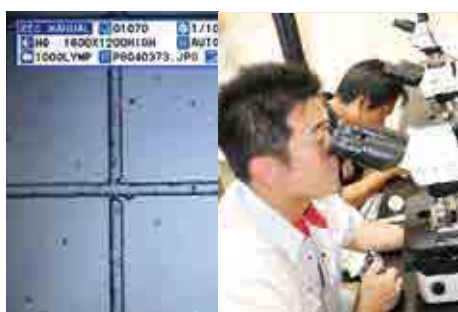
顕微鏡を巧みに操作しながら1mlあたりに含まれる有害プランクトンの数を数える職員
