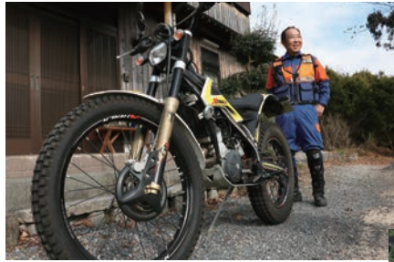
▲スペイン製の排気量250cc トライアルバイク。70kg程度 の軽量ボディで、意のままに 道なき道を突き進む
